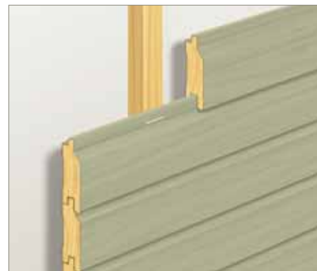
Das Cuba Profil wird ebenfalls verdeckt durch die Nagelfuge montiert. Das Brettende sollte auf der Unterkonstruktion liegen.
