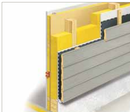
Wandaufbau bei Holzskelettbauweise
